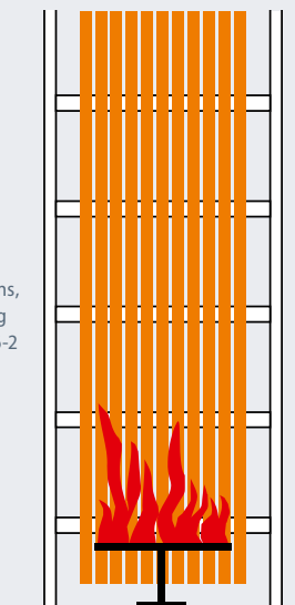
Fig. 2 Brandverhalten von Kabelbündeln, Prüfanordnung nach IEC 60332-3, EN 50266-2
